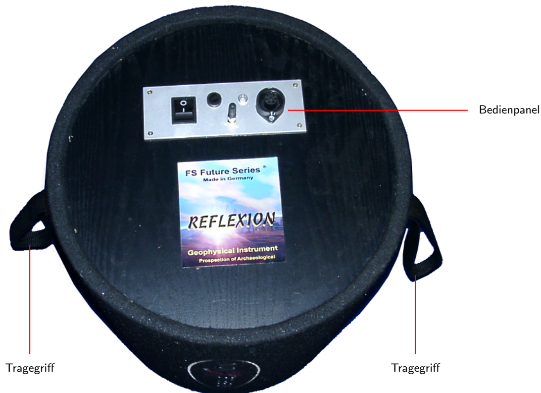
Abbildung 5: Sendemodul mit seinen Bestandteilen
