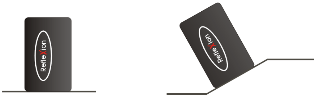
Abbildung 37: Richtiges Aufstellen des Sendemoduls
