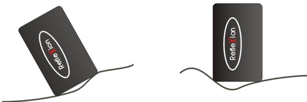
Abbildung 38: Falsches Aufstellen des Sendemoduls
