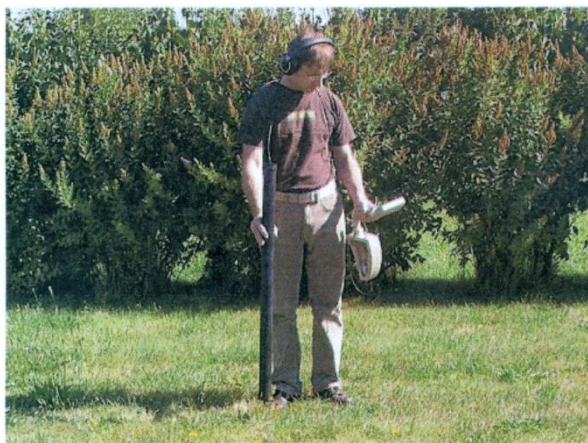
ΣΧΗΜΑ vo. 7.9 Η θέση που πρέπει να έχει η κεραία Super Sensor κατά την έρευνα
