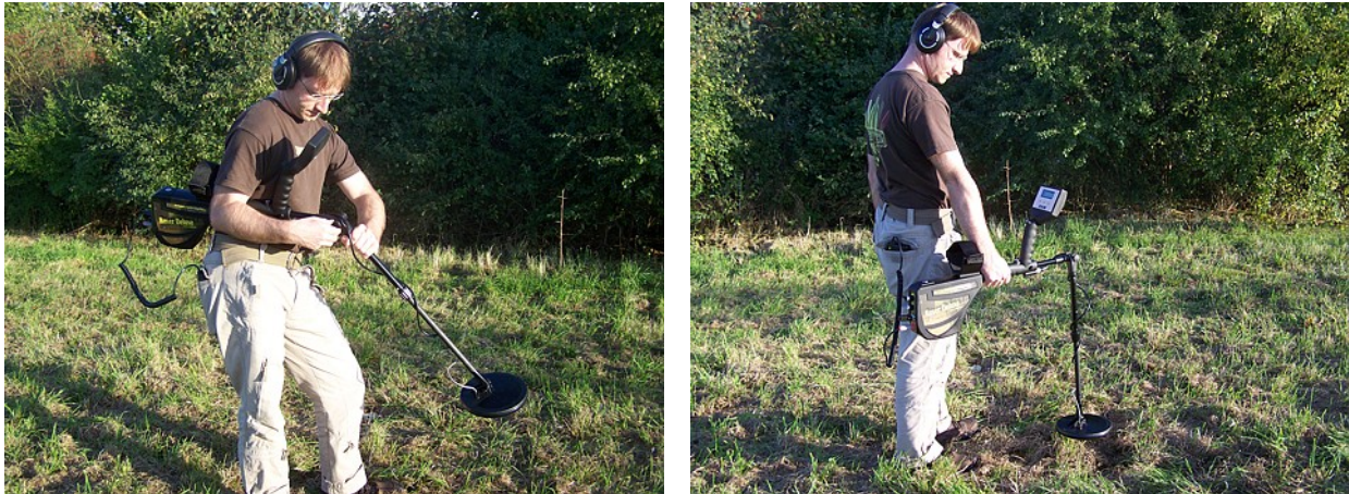
Abbildung 7.6: Die Suchspule wird in der Betriebsart "Ground Scan" abgeknickt
