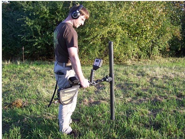
Abbildung 7.9: Haltung der Supersonde während der Messung
