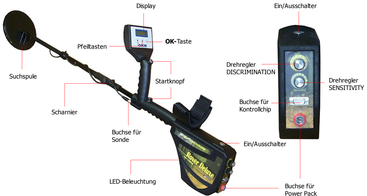
Abbildung 5.1: Übersicht der Bedienelemente der Kontrolleinheit
