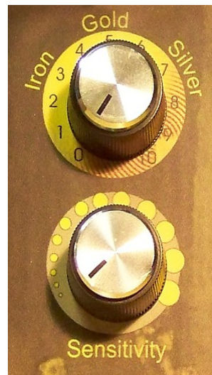
Abbildung 7.4: Bedienfeld für die Betriebsart "Metal Detector"
