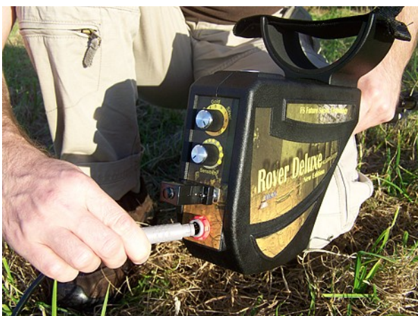
Abbildung 6.6: Power Pack zur Stromversorgung anschliessen
