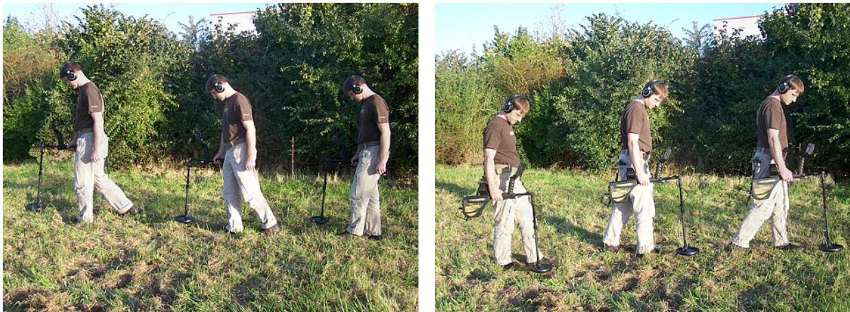
Abbildung 7.8: "Zig-Zag" Messung im Ground Scan
