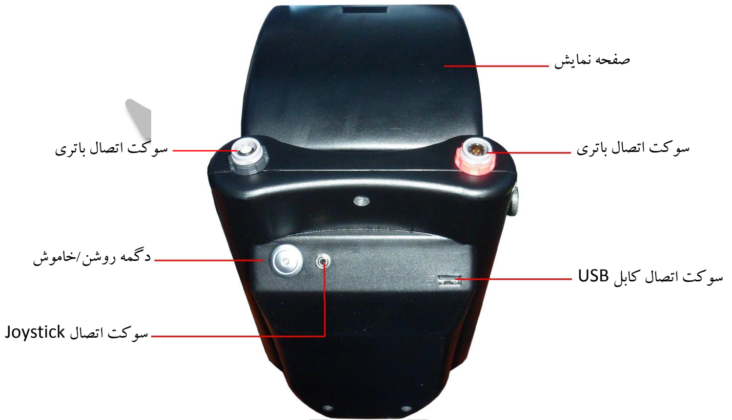
تصویر ۳-۶. نمای خلفی واحد کنترل
